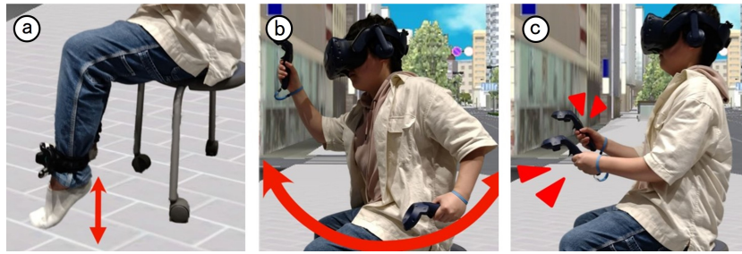
図 2 入力手法. (a) 踵上げ：足の踵を交互に上げ下げする動作, (b) 腕振り：両腕を前後に自然に振る動作, (c) 握りこみ：コントローラのボタンを左右交互に握る動作.
