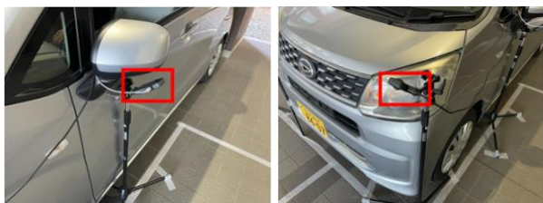
図4: サイドミラー下に配置したカメラ 図5: ヘッドライト横に配置したカメラ
