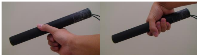
(a) 筆の持ち方 (b) ナイフの持ち方 図 3 デバイスの持ち方の違い
