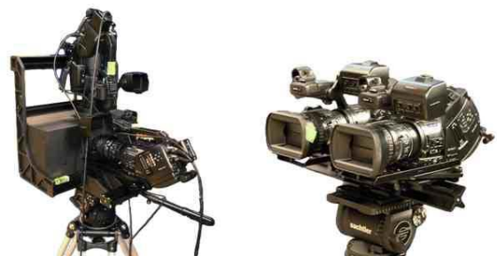
図 1 基線長と輻射角を変更可能な映画撮影用ステレオリグ (左: ビームスプリッターリグ, 右: 平行リグ)
