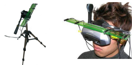
図1 マイクロホンアレー外観 (左:据置型, 右:ウェアラブル型)
