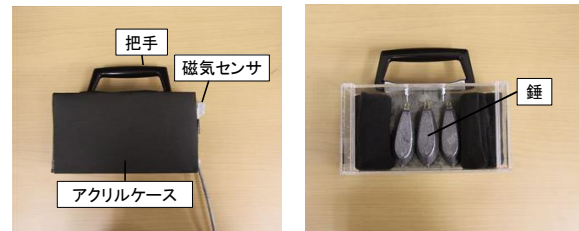
(a) 実物体の外 (b) 実物体の内部 図 2 実験で使った実物体
