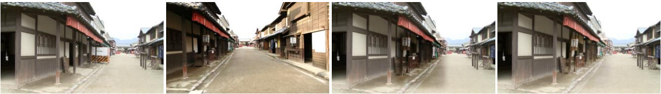
図7 Phase 3.5における光学的不整合へ対処 (左から、現画像、隠背景データ、Phase 3でのDR処理結果、Phase 3.5でのDR処理結果)
