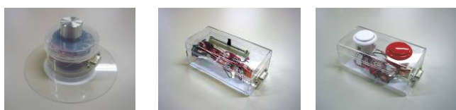
(a) ダイヤル式 (b) スライド式 (c) スイッチ式 図4 TUIコンポーネント
