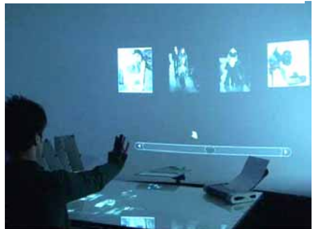
図 2 WATARI システム 壁面と卓上への映像投影と実物体を利用
