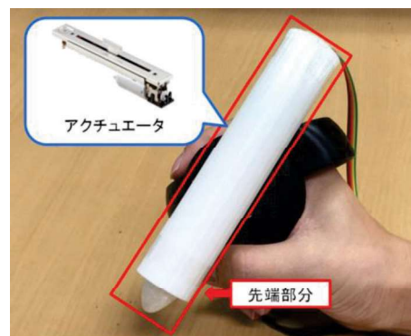
図3 先端伸縮機構を有するデバイス
