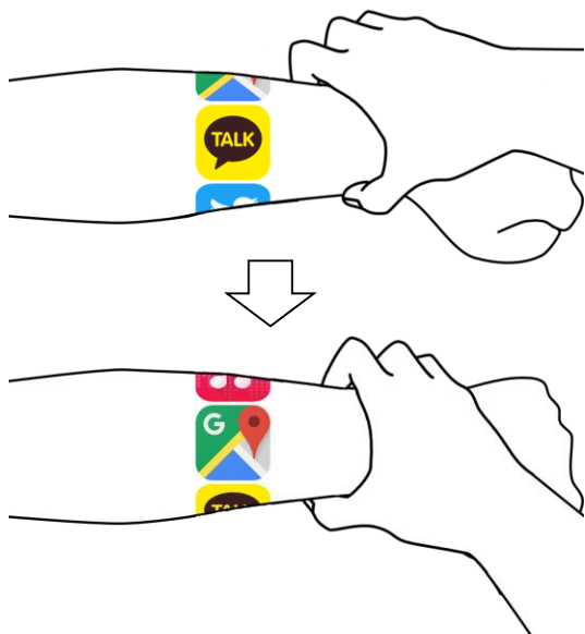
図3 回転インタラクション Fig.3 Rotating interaction technique using forearm.
