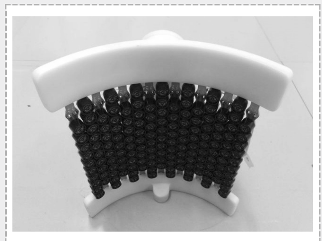
図5 超音波素子を凹曲面形状に配置したスピーカ
