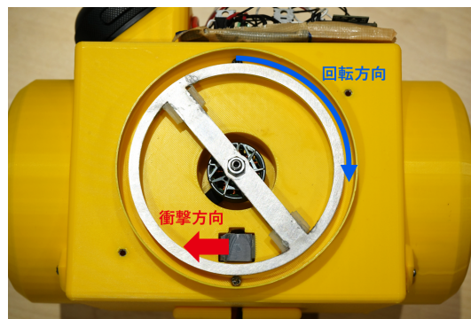
図2 フライホイールによる衝撃提示例
