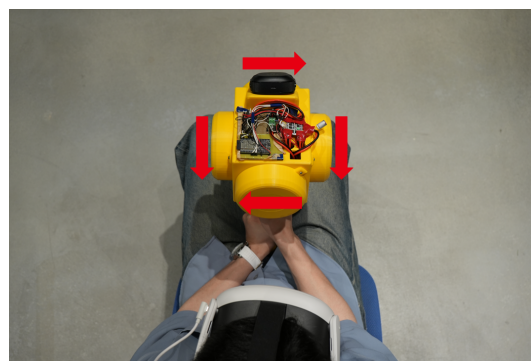
図3 各フライホイールユニットの衝撃方向
