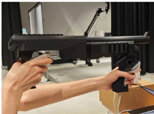
図5 3D プリントされた銃型コントローラ
