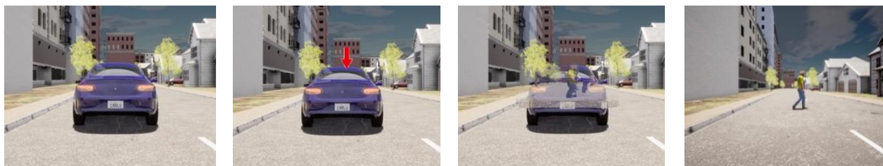
(A) 支援無表示方式 (B) アイコン表示方式 (C) 半隠消表示方式 (D) 他車両視点
