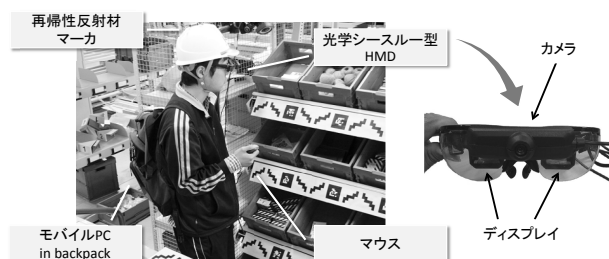
図 13 作業風景と本実験で使ったデバイス Fig.13 Work and device using this experiment
