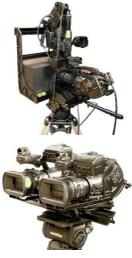
**Fig. 1.** Stereo rigs (Top: Beamsplitter rig. Bottom: Parallel rig)
