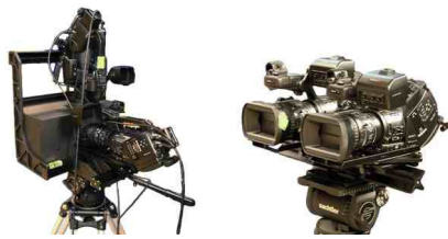
図3 製作したステレオリグ Nac 3D Rig II (左:ビームスプリッタリグ, 右:平行リグ) Fig. 3 Nac 3D Rig II for S3D MR-PreViz system (Left: Beam-splitter rig, right: parallel rig)
