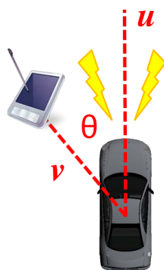
図8 内積による角度検出
