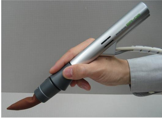
図 4 視触覚提示機構内蔵筆型デバイス (再設計後)
