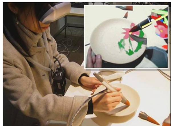
図1 筆型デバイスを用いた複合現実型描画システム
