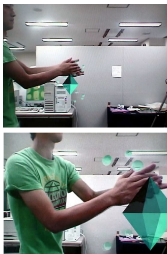
図 11 音源位置に CG オブジェクトが重畳描画されている様子
