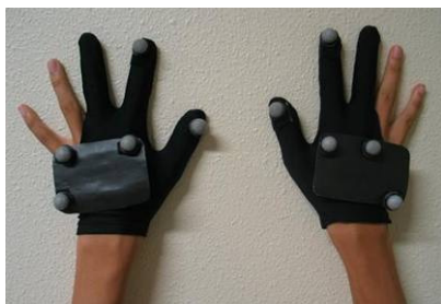
図3 ジェスチャ入力のための手袋状デバイス Fig. 3 Glove device for gesture detection
