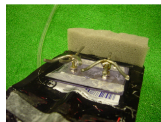
図 6 鳥の足を模した軽金属付加物 Fig. 6 Light metal attachment imitating bird legs
