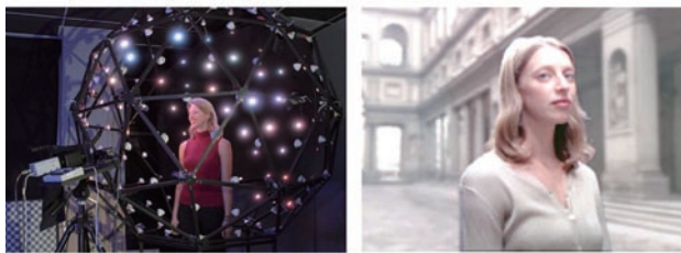
図-3 (左)色の变化する LED で俳優を何度も照射。 (右)撮影現場の照明に応じた CG の俳優を生成 (Paul Debevec 氏提供)
