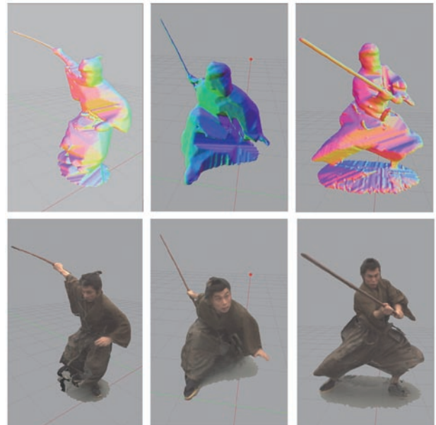
図-6 3次元ビデオの生成例。上：視体積法で再構成したポリゴンデータ (色は法線方向を示す)、下：実写テクスチャのマッピング結果
