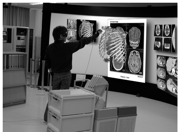
図3 3D物体の飛び出し感を与える表示(パースを合わせた嵌め込み合成図)
