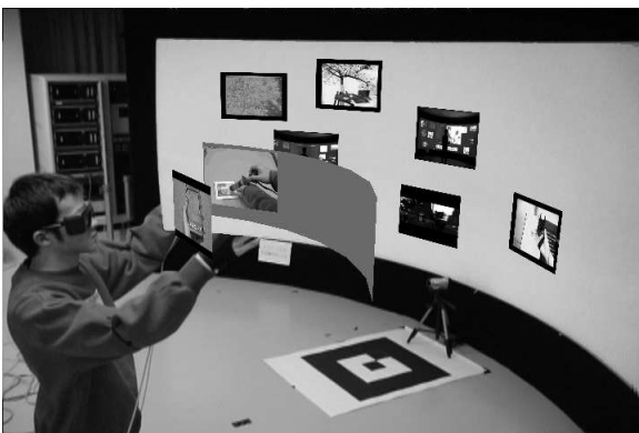
図 11 あるカメラ位置では操作者の手が隠蔽される
