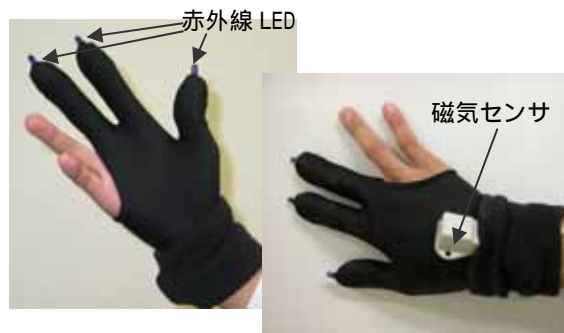
図 3 ジェスチャ入力のための手袋デバイス
