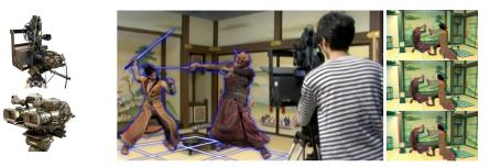
**Fig. 1.** Stereo rigs (Top: Beamsplitter rig. Bottom: Parallel rig)
