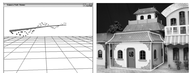
図 1 精度の計測方法。左図は、3 次元空間におけるカメラ位置の誤差を示したもので、右図は、2 次元空間における CG の再投影誤差を示したものである。
